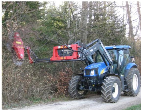
Mit der hydraulisch angetriebenen Frontlader Astsäge werden hohe Schnittgeschwindigkeiten bei einem sauberen Schnitt erreicht. Daraus resultiert eine hohe Stundenleistung. Der Rückschnitt von Hecken an Feld- und Waldrändern, Bachläufen und das Zurückschneiden von Heckenbewuchs an Strassen wird effizient und schonend erledigt.
