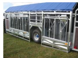
ridelles lateral, facilement extensible, (option), sol en caoutchouc vulcanisé (standard au modèles 31000, option au modèles 30000), Hauteur d'entrée 11 cm, construction solide de toit avec une bâche robuste
