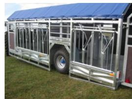
Fanggatter (Option), leicht teleskopierbar, hinten angeschlagen, Boden aus vergossenem Gummiganulat bei Modellreihe 31000 inklusive und als Option bei Modellreihe 30000, Einstiegshöhe 11 cm, robustes Dachgestell mit Plane
